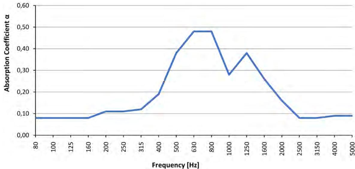
Schallabsorptionskoeffizient in der Alpha-Kabine nach DIN EN ISO 354 (12/2003)
